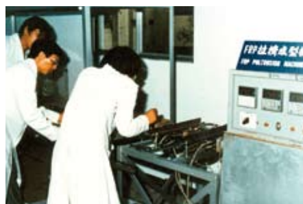
於防空洞實驗室中自行設計之拉擠成型機
