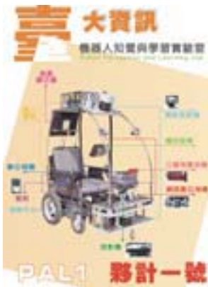
■ 競賽時使用之海報，其中展示機器人 PAL1 裝置的各種感測器
