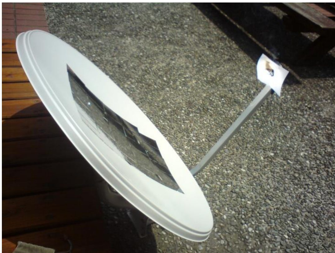
圖十一. 貼有鋁箔貼紙的碟型天線
