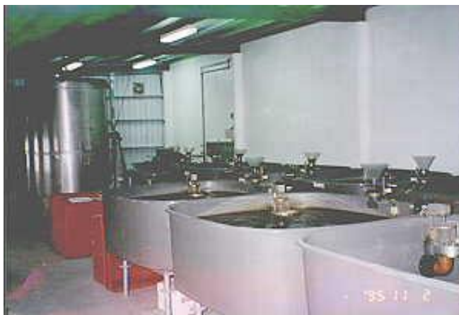
圖一. 農委會水產試驗所之室內超集約循環水養殖系統[4]
