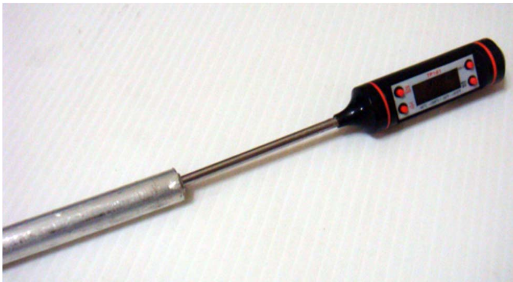
(圖十二)、置入型電子溫度計用來檢測水在加熱之後是否有達到沸點
